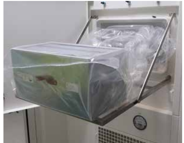
Mobiler Arbeitstisch für vereinfachten Filterwechsel Mobile work table for simplified filter changes
